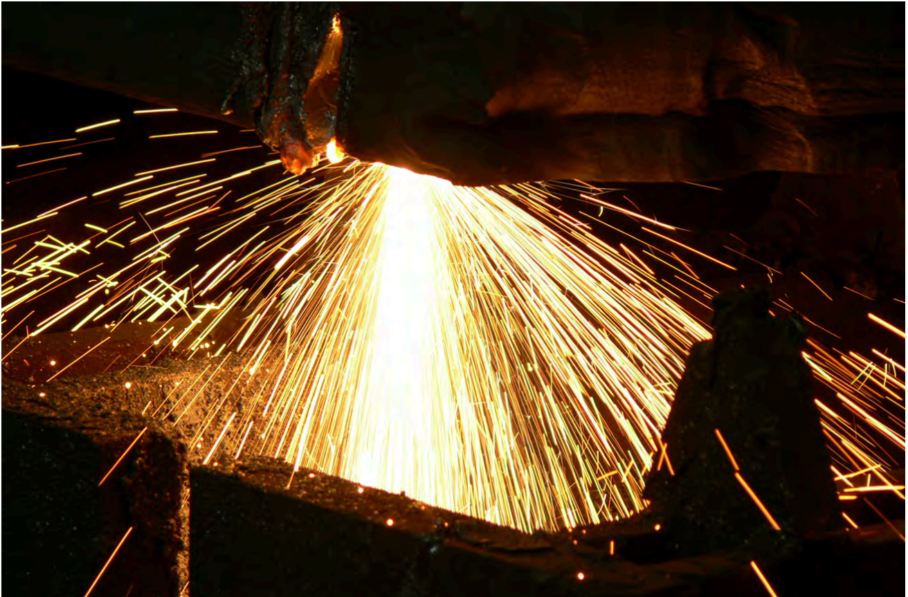
Abb. 82: Detailaufnahme des autogenen Brennschneideverfahrens bei der Herstellung einer Skulptur Lechners.
