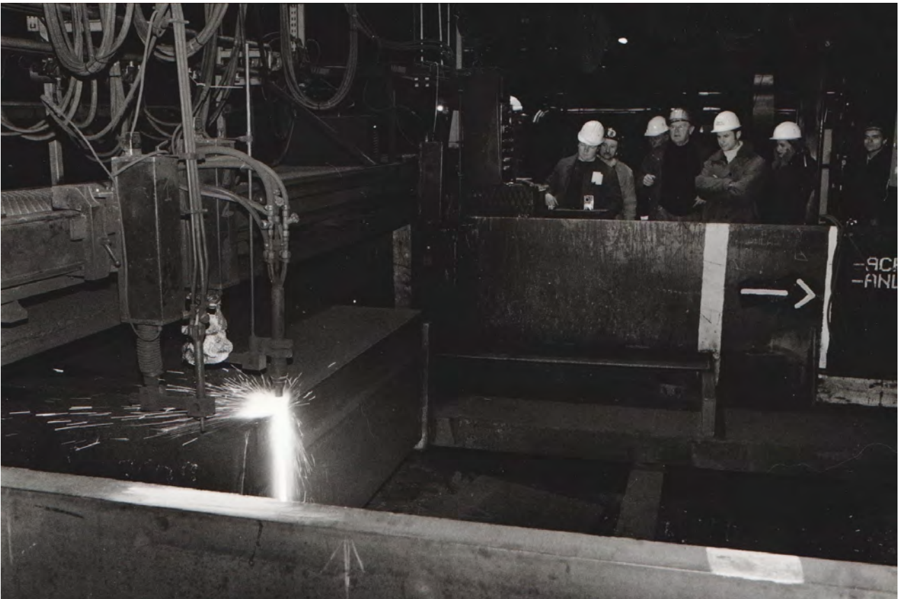
Abb. 95: Autogenbrennvorgang in der Dillinger Hütte für Bizarre Flächen.
